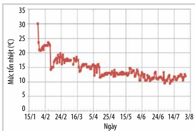
Hình 5. Tồn nhiệt của tuyến đường ống.
